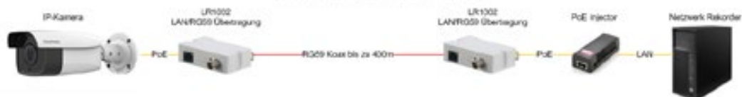
Ethernet über RG59 Koaxkabel
