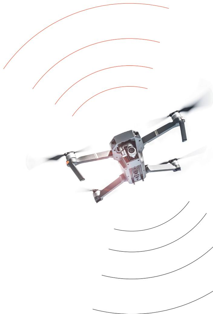
**Das Dedrone-System** sammelt Informationen verschiedener Sensoren, analysiert sie und löst eine Reaktion aus. Unsere Software ist „Sensoragnostisch“, das bedeutet, dass verschiedene Detektionstechnologien mit ihr verbunden werden können. [DroneTracker](#), Dedrones Machine-Learning Software führt die Daten aller Sensoren zusammen, um umgehend entscheiden zu können, ob eine Drohne eine Bedrohung darstellt oder nicht.
